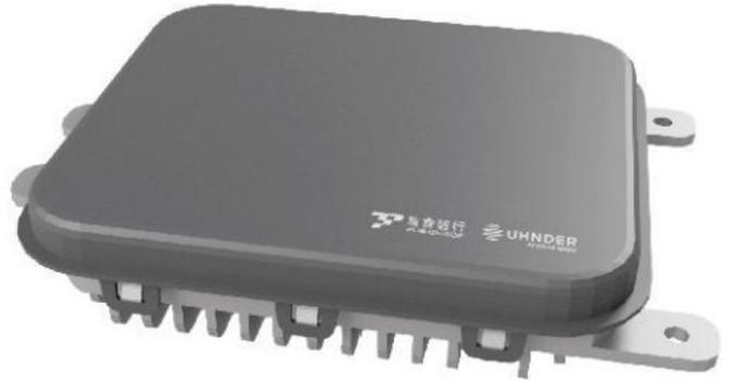
复睿智行与UHNDER 合作研发的12发16收成像雷达，采用新的PMCW 波形和信号处理方式，实现了更好的动态范围和成像能力。
